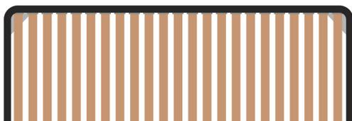
**STANDARD:** Rete con telaio rettangolare, angoli arrotondati e verniciature in polveri epossipoliesteri cotta a 180°C. Doghe in faggio sagomato a caldo, infilati in appositi alloggiamenti ricavati nel telaio 50x25mm. Elementi di fissaggio in plastica.
